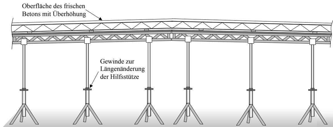
Bild 6.10 Herstellung einer Überhöhung im Stahlbetonbau
